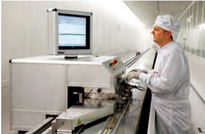
30 m长测量机应用的钢带光栅尺
